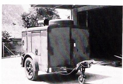
Der abgebildete Küchenanhänger Modell 42 (er wiegt 1250 kg, trägt eine Nutzlast von 1100 kg und misst – fahrbereit – 4 m in der Länge, 2,1 m in der Höhe und 2,3 m in der Breite) kann gekauft werden. Die Kriegs-
