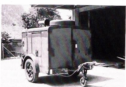
Der abgebildete Küchenanhänger Modell 42 (er wiegt 1250 kg, trägt eine Nutzlast von 1100 kg und misst – fahrbereit – 4 m in der Länge, 2,1 m in der Höhe und 2,3 m in der Breite) kann gekauft werden. Die Kriegs-
