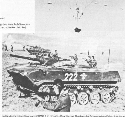
Luftlande-Kampfschützenpanzer BMD-1 im Einsatz – Beachte das Absetzen der Schwerlast am Fallschirmbündel
