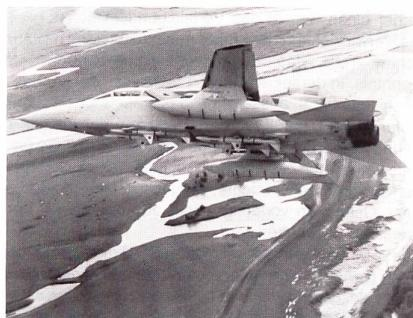
mit Übungsbomben mehrere Volltreffer erzielt werden. Im Ernstfall würden solche Panzerziele mit der Hilfe des Grossraum-Streuwaffendispensers MW-1 (Bild) bekämpft, wobei als Submunition die Hohlladungskleinbombe 44 (KB44) und/oder die Lauermunition MIFF (Mine-Flach-Flach) mit doppelter Flachkegeldung eingesetzt würde.
