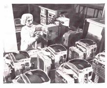
El Segundo, Kalifornien, Februar 1983 (UNS): Testarbeiten mit dem thermischen Sichtsystem, das den Besatzungen des neuen M1-Abrams-Kampfpanzers der US Army eine Zielfindung im Gefechtsgelände bei Nacht ebenso wie bei Rauch und Nebel ermöglichen soll, werden zurzeit von der Technischen Abteilung der Hughes Aircraft Co durchgeführt.
