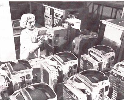
Ei Segundo, Kalifornien, Februar 1983 (UNS): Testarbeiten mit dem thermischen Sichtsystem, das den Besatzungen des neuen M1-Abrams-Kampfpanzers der US Army eine Zielfindung im Gefechtsfeld bei Nacht ebenso wie bei Rauch und Nebel ermöglichen soll, werden zurzeit von der Technischen Abteilung der Hughes Aircraft Co durchgeführt.
