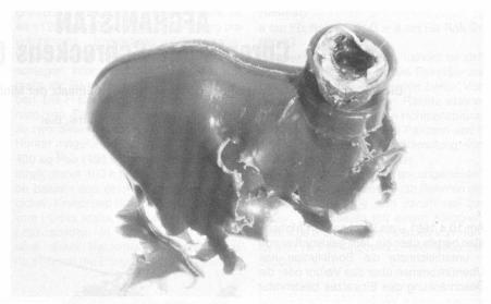
2 Die Überreste einer Plastik-Miniaturpersonenmine VGM mit der Bezeichnung 572/21 nach deren Explosion-Gut erkenntlich ist auf Foto Nr 3 der in der Mitte angebrachte Sprengzünder. Die abgebildete Mine VGM ist von olivgrüner Farbe.
