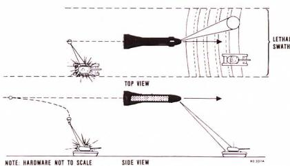
Selbständige Zielauffassung und -bekämpfung durch einen mit Millimeterwellenradar-, Wärmebild-, SAR- oder Passiv-Radar-Sensoren bestückten LAD mit intelligenten Submunition (zB ERAM) ka
