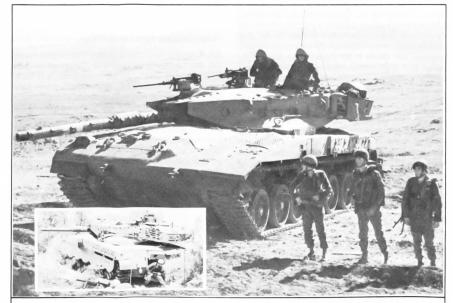
4 Mann (+ 6 Infanteristen) Besatzung Abmessungen Länge 8,63 m Breite 3.72 m 2,64 m Höhe Kampfgewicht 56 t Triebwerk vorne, teilweise
