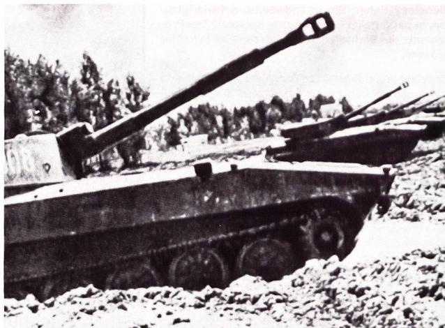
Blick in die Feuerstellung einer russischen Panzerhaubitzen-Abteilung Kaliber 15,2 cm. Beachte: Geschütze auf einem Glied. Zwischenraum 30–50 m. Schiessen in der untern Winkelgruppe
