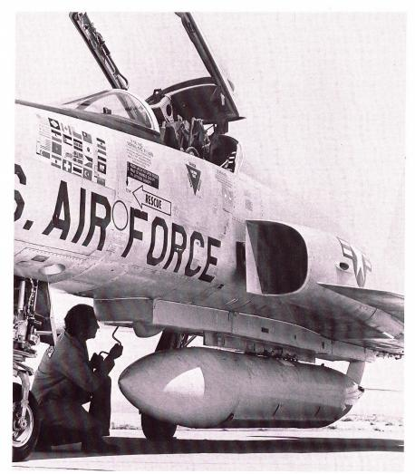
Northrop AN/ALQ-171 ECM Behälter unter dem Rumpf eines F-5E Tiger II. Dieses Bild zeigt deutlich, dass auch mit diesem ECM Behälter noch die volle Unterrumpfzuladung mitgeführt werden kann. Der AN/ALQ-171 ECM Behälter wurde von Northrop in Zusammenarbeit mit der Gruppe für Rüstungsdienste für die F-5E/F Tiger der Flugwaffe konstruiert.
