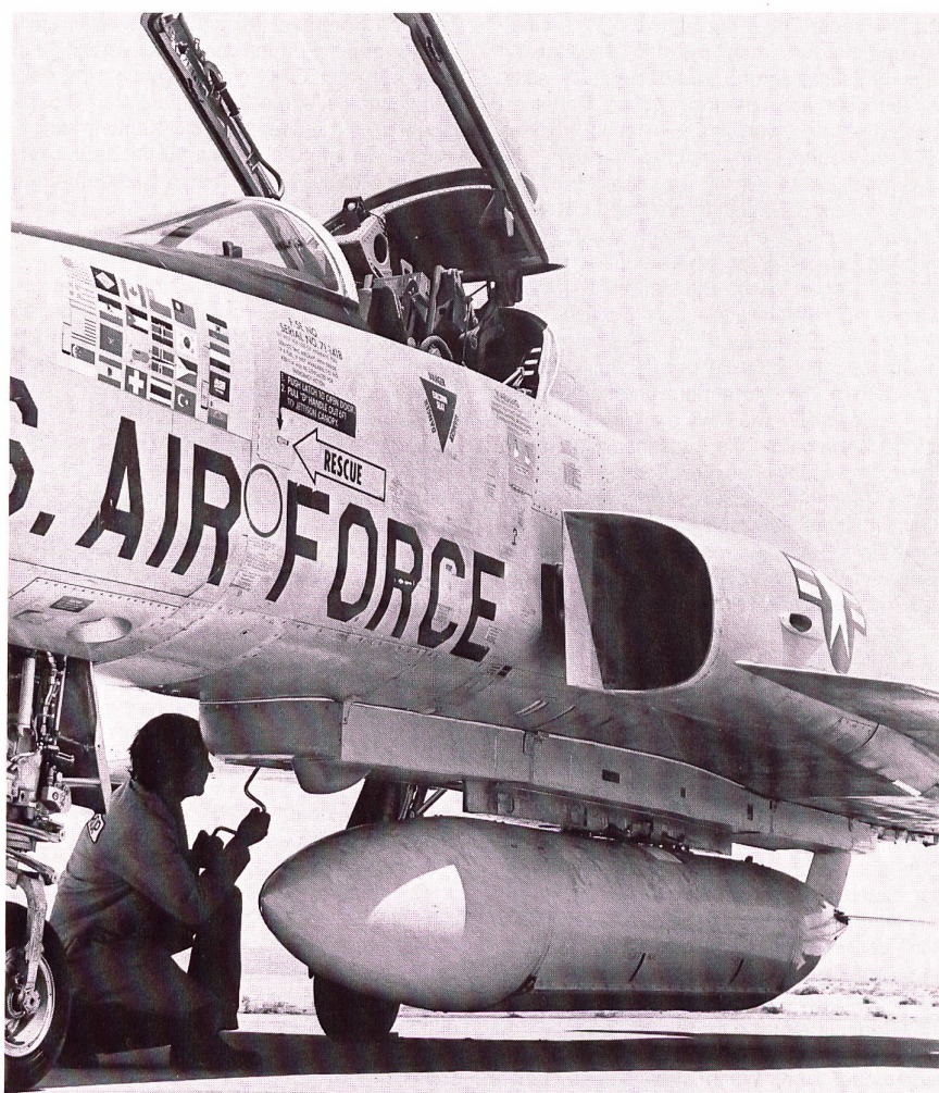
Northrop AN/ALQ-171 ECM Behälter unter dem Rumpf eines F-5E Tiger II. Dieses Bild zeigt deutlich, dass auch mit diesem ECM Behälter noch die volle Unterrumpfuladung mitgeführt werden kann. Der AN/ALQ-171 ECM Behälter wurde von Northrop in Zusammenarbeit mit der Gruppe für Rüstungsdienste für die F-5E/F Tiger der Flugwaffe konstruiert.
