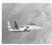
An ihrem rumpfkonformen Brennstoffzusatzbehältern führt diese F-15 Eagle an kleinen Stummelträgern insgesamt 12 x 227 kg Mehrzweckbomben Mk82 mit. Diese widerstandsarme Aufhängeart vergrössert den
