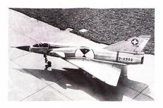
Am 23. August 1983 absolvierte die mit Entenflügeln ausgerüstete Dassault Mirage IIIS J-2302 im Flugzeugwerk Emmen ihren Erstflug in der neuen Konfiguration. Von dieser Änderung wird eine wesentliche Erhöhung der Manövrierfähigkeit des Flugzeugs im Kurvenkampf erwartet.
