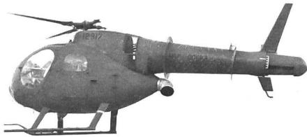
Am 17.12.1981 erfolgte der Erstflug des Hughes Experimentalhubschraubers NOTAR (No Tail Rotor). Bei diesem umgebauten OH-6A ist der übliche Heckrotor durch ein drehmomentstabilisierendes Jet-Düsensystem im Heck ersetzt. Ein einsatzfähiges NOTAR-System würde vor allem eine bessere Manövrierefähigkeit und grösere Flugsicherheit für Helikopterbesatzungen bei Missionen im Geländefolgeflug (Nap-of-the-Earth) offerieren.
