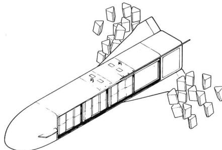
4-Schacht-Version für das kontrollierte Abdecken einer Bodenfläche mit Tochtergeschossen der Antiarmor-Cluster-Munitionsklasse.
