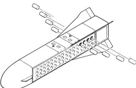
Rohr-Dispenser-Version für den Transport und Ausstoss von Submunition hoher Anfangsgeschwindigkeit (zB MW-1-Typen, Combined Effects Bomb und Antimaterial Incendiary-Geschosse). 48 Magazine des Kalibers 135 mm.
