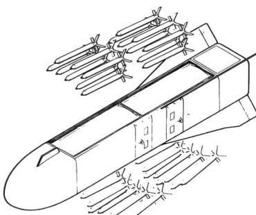
2-Schacht-Version für den Transport und Abwurf von Penetratoren hoher kinetischer Energie wie z.B. die Clustered Airfield Defeat-Munition.
