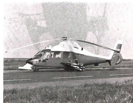
Die Marineversion des Hubschraubers Dauphin 2 startete am 4.3.1982 zu ihrem erfolgreichen Erstflug. Die von Saudi-Arabien in Auftrag gegebene Maschine trägt die Bezeichnung SA365N und ist mit dem Seeziel-Flugkörperlenkwaffensystem AS15TT ausgerüstet. Basierend auf dem von der amerikanischen Küstenwache bestellten Dolphin-Drehflügler, wird die
