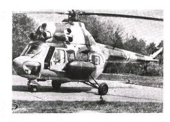
2365 kg, kann bis zu 4000 m hoch fliegen mit einer Reisegeschwindigkeit von 200 km/h. Die Bewaffnung besteht aus Mg, Kanonen oder Raketen. Besatzung bis 9 Mann. O B
