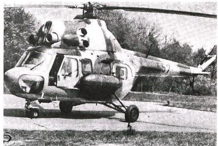
2365 kg, kann bis zu 4000 m hoch fliegen mit einer Reisegeschwindigkeit von 200 km/h. Die Bewaffnung besteht aus Mg, Kanonen oder Raketen. Besatzung bis 9 Mann. O B
