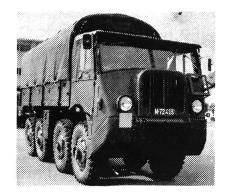
Nutzlast: 3,5/5,0 t Dieselmotor: 6 Zylinder 85/100 PS Getriebe: 10 Vorwärts-, 2 Rückwärtsgänge Seilwinde: Zugkraft 5000 kg, Seillänge 60/70 m Anhängerbetrleb: voll eingerichtet (grosse Luftreserve) Preis: günstig, je nach Zustandsrapport
