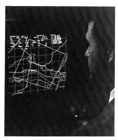
Die von Hughes Aircraft Company im Rahmen eines DARPA-Auftrages in Konkurrenz zu Norden ausgelegte Pave-Mover-Radar-Zielauffass- und Waffenleitanlage demonstrierte kürzlich an Bord eines F-111E-Schwenkflüglers ihre Einsatzfähigkeit. Pave Mover erfasste dabei das zu bekämpfende Erdziel und übermittelte via einer mobilen Bodenstation Bahnkorrektursignale an die zu dessen Bekämpfung eingesetzten T-16 Boden/Boden-Lenk-
