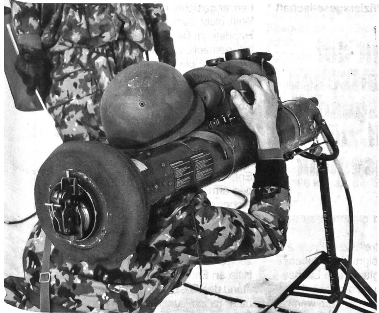
1 Auch in Häusern untergebrachte, feindliche Stellungen, können dem Dragon als Ziel dienen. Das Bild ist aber eine Täuschung, denn der Schütze richtet seine Waffe auf das sich im Zielgelände bewegende Fahrzeug. Am Rücken hängt die Tragtasche für das Zielgerät, welches immer wieder verwendet werden kann.
