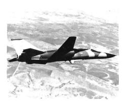
gerüstet. Die das Schwenkflügel-Tiefangriffsflugzeug F-111F fliegende Einheit wird dank der AN/AVQ-26-Anlage fähig sein, selbst bei Nacht und schlechtem Wetter konventionelle, laser- und wärmebildgesteuerte Abwurfwaffen und Lenkflugkörper im ersten Anflug einsetzen zu können. Gleichzeitig dient die Pave Tack Gondel zur Navigation und dem Aufdatieren der vom Geländefolgeradar gelieferten Ausgänge. Unsere Foto zeigt einen F-111F mit der Pave-Tack-Anlage halbversenkt im Waffenschacht.
