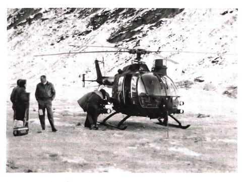
Der Panzerabwehrhelikopter BO-105 CB der Firma Messerschmitt-Bölkow-Blohm (MBB) in Hinterrhein. An seitlichen Abschussvorrichtungen kann er 8 Lenkwaffen des Typs «TOW» mitführen. Der Aufbau über der linken Seite der Kabine stellt die optische Zielvorrichtung dar.
