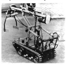
Die britische Armee hat ein Robotgerät entwickelt, mit dem es möglich ist, ohne Gefährdung von Menschen verdächtige Fahrzeuge zu untersuchen und Minen zu entschärfen. Sprengstoffexplosionen aller Art haben bis jetzt bei der Terroristenbekämpfung viele Opfer gekostet. Das nun in Nordirland eingesetzte Gerät soll sich ausgezeichnet bewähren.
