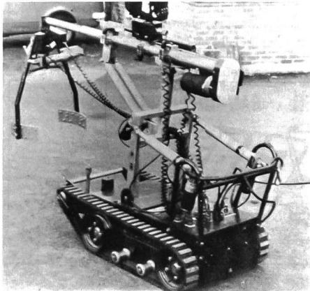
Die britische Armee hat ein Robotgerät entwickelt, mit dem es möglich ist, ohne Gefährdung von Menschen verdächtige Fahrzeuge zu untersuchen und Minen zu entschärfen. Sprengstoffexplosionen aller Art haben bis jetzt bei der Terroristenbekämpfung viele Opfer gekostet. Das nun in Nordirland eingesetzte Gerät soll sich ausgezeichnet bewähren. Spooner/Dukas
