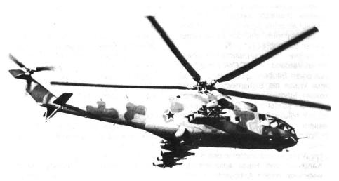
Modernste Waffen im Einsatz gegen die Widerstandskämpfer. Kampfhelikopter Mi-24 HIND, bewaffnet mit Mg/ Bordkanone, Raketen, Bomben, Lenkwaffen und zusätzlicher Transportkapazität für 8–10 Soldaten.
