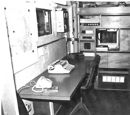
Im Einsatz stand auch diese mobile Einsatzzentrale. Der in eigener Regie um- und ausgebaute geländegängige Sanitäts-Mowag – ausgerüstet mit Notstromaggregat, Lichtmast, Funk mit Zerhacker, Tonbandgerät, Schreibmaschine, Vervielfältigungsapparat, Kartenmaterial usw – hat sich als KP-Front bereits in mehreren Einsätzen bestens bewährt.
