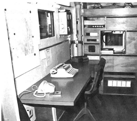
Im Einsatz stand auch diese mobile Einsatzzentrale. Der in eigener Regie um- und ausgebaute geländegängige Sanitäts-Mowag – ausgerüstet mit Notstromaggregat, Lichtmast, Funk mit Zerkhacker, Tonbandgerät, Schreibmaschine, Vervielfältigungsapparat, Kartenmaterial usw – hat sich als KP-Front bereits in mehreren Einsätzen bestens bewährt.
