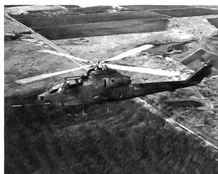
Bell Helicopter Textron schlägt als kostengünstigste Alternative zum AH-64A Apache «Advanced Attack Helicopter»-Waffensystem einen «Enhanced Cobra» genannten Kampfdrehflügler vor. Der auf dem YAH-1S Cobra 249 basierende Heli-Kopter-Entwurf zeichnet sich durch
