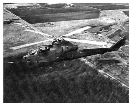
Bell Helicopter Textron schlägt als kostengünstigste Alternative zum AH-64A Apache «Advanced Attack Helicopter»-Waffensystem einen «Enhanced Cobra» genannten Kampfdrehflügler vor. Der auf dem YAH-1S Cobra 249 basierende Heli-Kopter-Entwurf zeichnet sich durch
