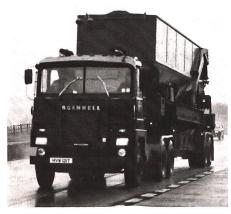
Kein Mensch vermutet, dass es sich bei diesem «Lastwagen» um eine fahrbare Radarstation handelt.
