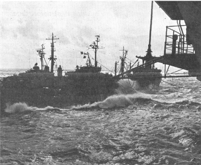
Das «Replenishment» ist in vollem Gange. Ein Tanker ist längsseits gekommen und hat mit dem Träger verschiedene Leinenverbindungen hergestellt. Gleichzeitig übernimmt auch ein Zerstörer das kostbare Oel. Official US Navy Photo
