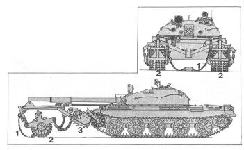
Minenräumpanzer. (Modifizierter Kampfpanzer mit «Minenräumgerät») Das Räumgerät besteht aus drei Teilen:
