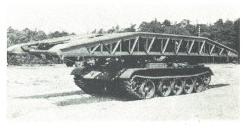
Brückenpanzer mit starrer Brücke. Technische Daten: Fachwerkkonstruktion von 12 m Länge, 3,3 m Breite. Nutzlast 50 t, Fahrzeuggewicht mit Brücke total 26 t, 2 Mann Besatzung, Bewaffnung 1 MG 7,62 mm im Bug
