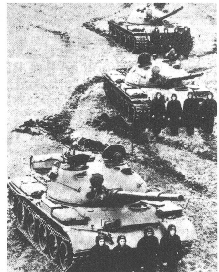
Dieser Typ ist eine Fortentwicklung des T-54/55, von dem er wesentliche Baugruppen übernommen hat. Er ist jedoch flacher als seine Vorgänger. Beim Fahrwerk fehlen die Stützrollen. Der Rauchabsauger im ersten Drittel der Kanone ist verstärkt worden. Der Panzer besitzt eine KC-Schutzvorrichtung und eine bordeigene Nebelanlage. AT
