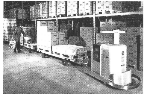
BARRETT-Elektro-Schlepper für manuelle Bedienung oder Funksteuerung oder fahrerlose elektromagnetische Steuerung
