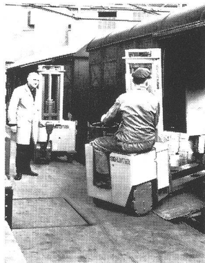
SIG-LIFTER Elektro-Pratzenstapler mit Quersitz- oder Deichsellenkung
