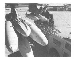
Für die Kampfflugzeugtypen A-10, F-16 (Bild), F-18 und AV-8B der USAF/USN befindet sich in den USA eine neue Aufhängevorrichtung für Kampfmittel und Behälter in Vollentwicklung. Die «Multiple Stores Ejector Rack» (MSER) genannte Vorrichtung erlaubt den Waffeneinsatz bis zu einer Geschwindigkeit von 1600 km/h und bei praktisch allen Angriffsprofilen. MSER unterscheidet sich von den heute im Truppendienst stehenden Waffenaufhängevor-
