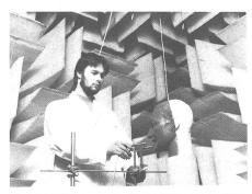
Ein Labortechniker regelt während Versuchen in einem schalltoten Raum des britischen Royal Signals and Radar Establishment (RSRE) die Lage eines Richtmikrofons. Durch die Versuche soll gemessen werden, wie das Mikrofon auf Umgebungsgeräusche reagiert, die um den «Kopf», auf den sie gerichtet sind, herumgebeugt werden. Durch Reduktion der Empfindlichkeit «unerwünschten» Geräuschen gegenüber, hoffen die Ingenieure die Mikrofone für öffentliche Beschallungs- und Tonaufnahmegeräte zu verbessern.
