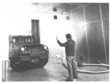
Ein Kommunikations-Raupenfahrzeug wird in einem speziellen, mit Metallegierung ausgekleideten Prüfraum des britischen Royal Signals and Radar Establishment (RSRE) eingefahren. Der abgeschirmte Raum ist vollkommen gegen externe Radar- und Radioemissionen abgedichtet und die Kommunikationsgeräte des Fahrzeugs können daher ohne Störung durch Aussengeräusche und elektromagnetische Effekte geprüft werden.
