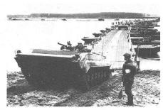
Leichte Panzerkampfwagen überqueren einen Fluss auf einer mobilen Pontonbrücke.
