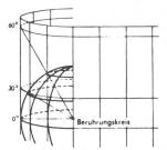
Fig. 1 Winkeltreue Zylinderprojektion
