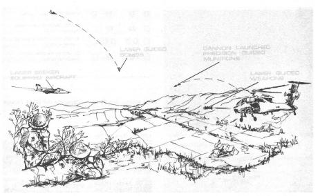
Der Einsatz von tragbaren Laserzielbeleuchtern im Rahmen von Luftnahunterstützungsmissionen veranschaulicht diese Zeichnung. Das zu vernichtende Ziel wird vom vorgeschobenen Fliegerleitoffizier oder Artilleriebeobachter mit einem Laserzielmarkierer ausgeleuchtet. Die dabei vom anvisierten Ziel reflektierte Laserenergie dient u.a. (von rechts nach links)
