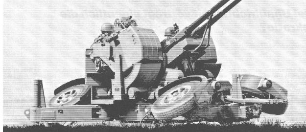
...und Objektschutz gleichermassen hervorragend geeignet. Durch die moderne Feuerleitanlage SKYGUARD gesteuert, bekämpfen die Oerlikon 35 mm Zwillingsgeschütze Flugziele bei jedem Wetter, im Tag- und Nachteinsatz, ungeachtet ihrer Anflugprofile, mit grösster Sicherheit und Wirksamkeit lückenlos im ganzen Abwehrbereich dank minimalem innerem Tatraum wehrbereich dank minimalem innerem Totraum, extrem hoher Schussfolge und Munitionswirkung.
