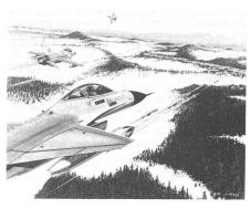
Die WASP-Lenkflugkörper offerieren eine Eindringtiefe von 10–12 km. Das Zielgebiet erreichen sie mit Hilfe einer integrierten Mitkurssteueranlage. Dort übernimmt der Zielsuchkopf die Steuerung in der Endanflugphase. Die Zielsuche, -identifikation und das Aufschalten geschieht selbständin
