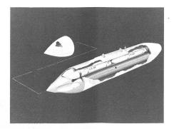
In diesem 4,7-m-Behälter mit einem Durchmesser von 0,635 m werden in sechs rohrförmigen Magazinen 12 WASP-Flugkörper gelagert. Im Einsatz können diese Raketen einzeln oder in Salven mit kurzen Intervallen gestartet werden. Der Pod, von dem die Flugzeugtypen F-111 und F-16 maximal je 4 und der A-10 Thunderbolt II 6 Einheiten mitführen können, wiegt einsatzbereit rund 907 kg.
