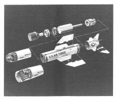
Aufbau des Panzerabwehrlenkflugkörpers WASP mit ausklappbaren Flügeln und einem fortgeschrittenen Hohlladungsgefechtskopf. Als Lenkmodul für die Endanflugphase prüft man je einen Millimeterwellenradar- und Zweifarben-Infrarot-Zielsuchkopf. Der WASP-Entwurf von Boeing misst 1,524 m in der Länge und wiegt rund 45 kg.
