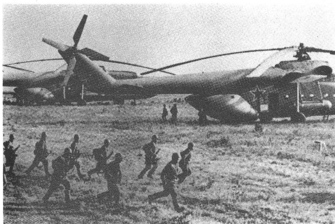
Der Mi-6 (HOOK) fasst bis zu 65 ausgerüstete Soldaten oder kann Materialtransporte bis zu einer Nutzmasse von 12 000 kg durchführen.
