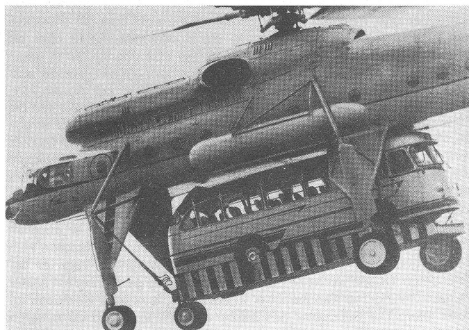
Mi-10 (HARKE), er vermag als «fliegender Kran» Materialtransporte bis zu 14 000 kg durchzuführen.
