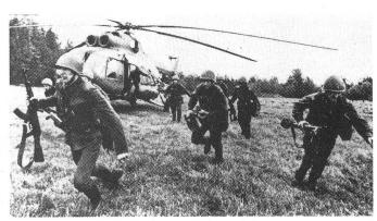
Der Mi-8 (HIP) kann als Standardhubschrauber für taktische Luftlandungen 28 ausgerüstete Soldaten oder 4000 kg Nutzmasse transportieren. Eine Bewaffnung mit Luft-Boden-Raketen und PAL ist möglich.
