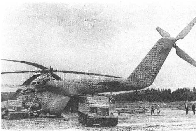
Der Mi-6 (HOOK) fasst bis zu 65 ausgerüstete Soldaten oder kann Materialtransporte bis zu einer Nutzmasse von 12 000 kg durchführen.
