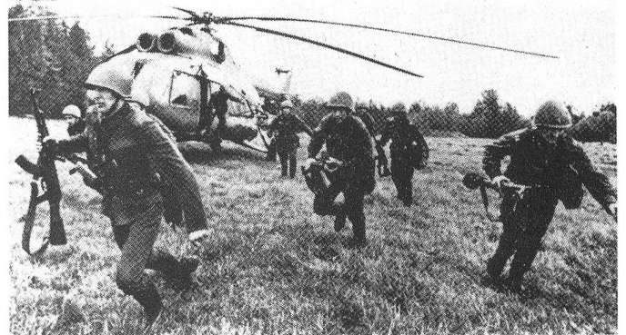
Der Mi-8 (HIP) kann als Standardhubschrauber für taktische Luftlandungen 28 ausgerüstete Soldaten oder 4000 kg Nutzmasse transportieren. Eine Bewaffnung mit Luft-Boden-Raketen und PAL ist möglich.
