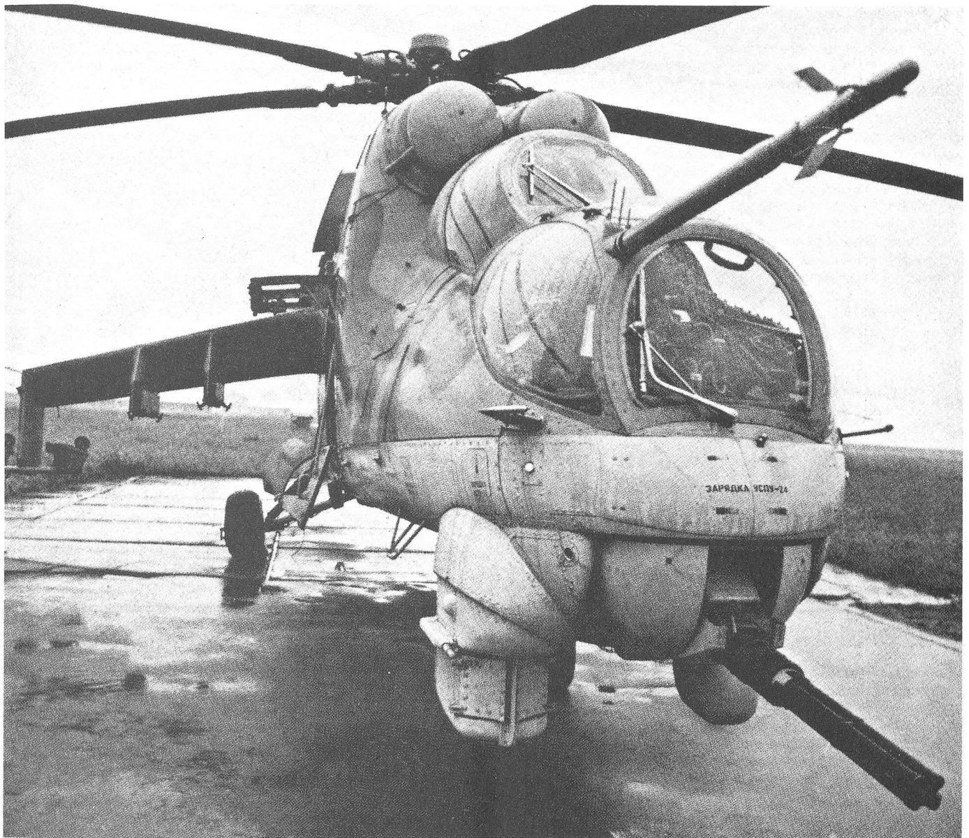
Mi-24 HIND. Mit dem folgenden Bild zusammen die wohl bis jetzt besten veröffentlichten Fotos (aus der tschechischen Revue Letectvi & Kosmonautica). Gut sichtbar sind Rumpfpkanone, Stummelflügel mit Aufhängevorrichtung für 2 Raketenpods (innen) und 2 Panzerabwehrenkwaffen (ausser). Pilot und Schütze sitzen hintereinander.
