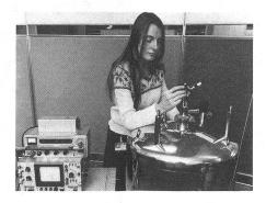
Die britische Marine der neunziger Jahre wird über ein kerntechnisches Trägheitsnavigationssystem verfügen, das auf der natürlichen Drehung der Atomkerne beruhen wird, und nicht auf der etwa für ein Spinnrad kennzeichnenden Trägheit. Hier wird im Laufe von am Admiralty Compass Observatory in Südengland durchgeführten Versuchen ein Prüfgerät an einen cryostatischen Kühlbehälter angeschlossen. Das neue System wird an dem Observatory entwickelt.
