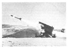
Eine Sparrow-Lenkwaffe wird vom Skyguard-Sparrow-Lenkwaffenwerfer abgeschossen. Dieser Werfer wird vom Contraves-Feuerleitsystem Skygard ferngesteuert und beleuchtet mit seinem Radar das Ziel.
