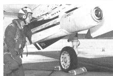
Eglin AFB mit der AGM-65E erfolgreich aus einem erdnahen Angriffsprofil auf eine Entfernung von 9 km einen ausgedienten Schützenpanzer. Die Markierung des Zieles erfolgte mittels eines bodengestützten Laserzielbeleuchters. Als weiteres interessantes Detail zeigt unsere Aufnahme die in der A-4M Skyhawk-Rumpfspitze eingebaute elektro-optische AN/ASB-19 (V) ARBS-Bordanlage (Angular Rate Bombing System) für die Zielauffassung und den Waffeneinsatz.
