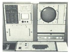
Der Trainingssimulator TS 2 für die Ausbildung der Truppe am Feuerleitgerat 75 Skyguard. Dank diesen Simulatoren können teure Flugstunden gespart, Fluglärm vermieden und trotzdem alle möglichen Situationen wirklichkeitsgetreu geprobt werden.
