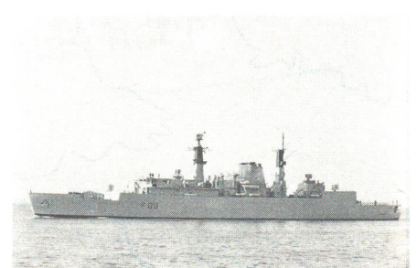
Die Raketenfregatte HMS «Battleaxe» (F 89) gehört zu der neuesten «Broadsword»-Klasse* Sie ist u.a. mit 4 Werfern für Schiff-Schiff Lenk Waffen und mit 2 Werfern (à je 6 Rampen) für Schiff-Luft Lenk Waffen des Typs «Sea Wolf» sowie mit 2 Helikoptern «Lynx» ausgerüstet. Das Schiff verdrängt knapp 4 t.* (Typ 22 Fregatten).
