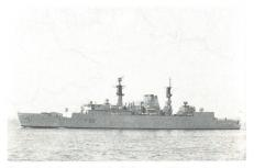
Die Raketenfregatte HMS «Battleaxe« (F 89) gehört zu der neuesten «Broadsword»-Klasse" Sie ist u.a. mit 4 Werfern für Schiff-Schiff Lenkwaffen und mit 2 Werfern (a je 6 Rampen) für Schiff-Luft Lenkwaffen des Typs «Sea Wolf» sowie mit 2 Helikoptern «Lynx» ausgerüstet. Das Schiff verdrängt knapp 4 t.\*(Typ 22 Fregatten).
