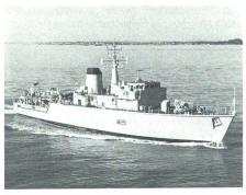
England zählt zu den führenden Nationen auf dem Minenkriegsektor. Dies ist um so wichtiger, als die amerikanische Marine praktisch keine aktiven Minenschiffe mehr besitzt. Hier ist die HMS «Brecon» zu erkennen, Leitschiff einer 12 Einheiten umfassenden neuen Klasse (Verdrängung 725 t). Bemerkenswerteste Neuheit an diesem Schiff ist dessen Glasfiberrumpf. Der Minensucher ist mit einer 40 mm Kannen bewafftet
