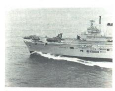
Drei sogenannte «Trough deck cruisers« sollen die konventionellen Träger der Royal Navy ablösen. Auf dieser Aufnahme ist das erste, im Jahre 1980 in Dienst gestellte Schiff der «Invincible»-Klasse (mit gleichlautendem Namen) zu erkennen. Die «Invincible» ist 207 m lang und verdrängt 16 257 t, die Besatzung zählt total 903 Mann. Im Vordergrund «schwebt» ein Senkrechtstarter des Typs «Sea Harrier», von dem inskünftig eine Staffel mit 5 Maschinen an Bord stationiert sein wird.
