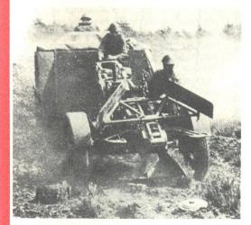
Minenleger-Anhänger für das rasche «halbmechanische» Verlegen von Panzerminen.
