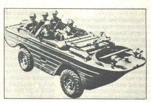
Schwimmfähiger Jeep. Gewicht 1,8 t, Länge 5 m, Breite 2 m, Höhe 1,8 m, Fasungsvermögen 1 Fahrer + 4 Mann, Motor 55 PS, Geschwindigkeit Land 80 km/h, Wasser 8 km/h. Fahrbereich 400 km. Zuteilung: Pionierbataillon der Panzer- und Mot Schützendivision
