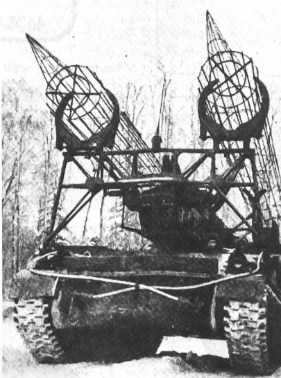
Diese Raketenimitation aus Stahlrohr soll Beschädigungen an den Flab-Raketen während der chemischen, taktischen und Fahrausbildung vermeiden. Fahrer sind so besser in der Lage, ein sicheres Gefühl dazu zu erhalten, ob eine Waldschneise ohne Gefahr für die Raketen noch passierbar ist oder nicht. O.B.
