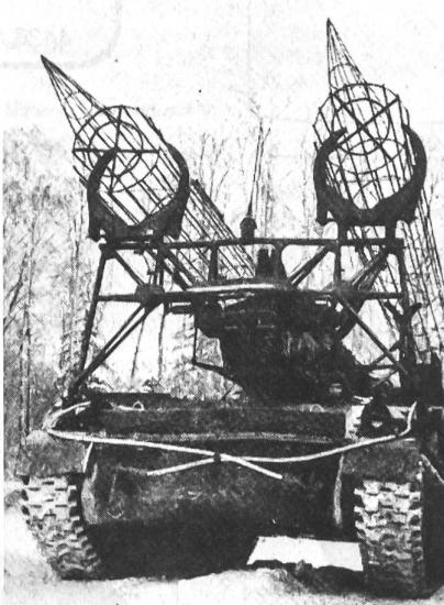
Diese Raketenimitation aus Stahlrohr soll Beschädigungen an den Flab-Raketen während der chemischen, taktischen und Fahrausbildung vermeiden. Fahrer sind so besser in der Lage, ein sicheres Gefühl dazu zu erhalten, ob eine Waldschnäuse ohne Gefahr für die Raketen noch passierbar ist oder nicht.
