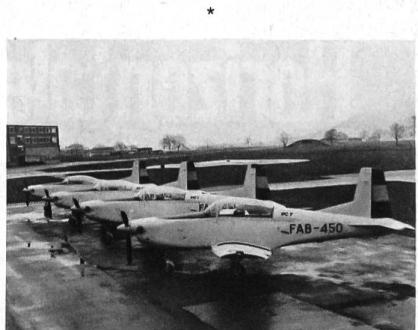
Der von einer Propellerturbine Pratt & Whitney PT6A-25A angetriebene PC-7 Grundschatrainer der Pilatus Flugzeugwerke AG in Stans steht bereits bei sieben Luftstreit-
