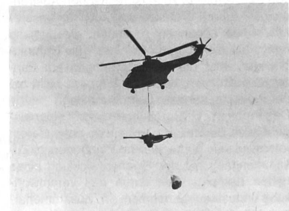
Der französische «Super Puma AS-332 B» beim Transport eines Artilleriegeschützes (2,5 t). Im Tragnetz werden 300 kg Munition mitgeführt. Die Geschützmannschaft (4 Mann) ist im Helikopter.
