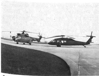
«Super Puma AS-332 B» der Firma Aérospatiale (links im Bild) und «Black Hawk UH-60 A» der Firma Sikorsky (rechts). Diese Helikopter sind in der Lage 12 bis 20 Personen zu transportieren und könnten vor allem bei den Gebirgstruppen eingesetzt werden.
