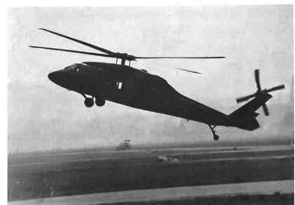
«Black Hawk UH-60 A» der amerikanischen Firma Sikorsky. Auffallend die gedrückte Silhouette. Die Radar- und visuelle Erkennung wird damit wesentlich erschwert.
