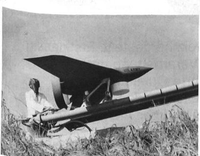
Basierend auf den mit dem Aquila-RPV gewonnenen Erfahrungen wird die Lockheed Missiles & Space Co. im Auftrage der US Army die Vollentwicklung eines Kleinfernlenk-Flugzeugsystems für Aufklärungs- und Ziemarkiermissionen ausführen. Das auf sieben Standard-LKW auf-
