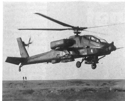
Der 3. Advanced -Attack-Helikopter-Prototyp ist mit einem beweglichen Heck ausgerüstet (Bild). Die den Namen «Stabilator» tragende, automatisch arbeitende Vorrichtung erleichtert dem Piloten das Fliegen des YAH-64-Drehflüglers im Geländegeflogen. Mit der Hilfe der im Rumpfbug eingebauten elektro-optischen TADS- (Target Acquisition/Designation System) Bordanlage wurden ferner Ziele aufgeforscht, ausgeleuchtet und anschliessend mit dem lasergesteuerten Hellfire-Flugkörper bekämpft. (ADLG 7/79) ka
