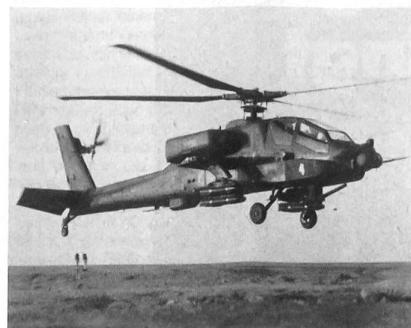
Der 3. Advanced -Attack-Helikopter-Prototyp ist mit einem beweglichen Heck ausgerüstet (Bild). Die den Namen «Stabilator» tragende, automatisch arbeitende Vorrichtung erleichtert dem Piloten das Fliegen des YAH-64-Drehflüglers im Geländegeflogen. Mit der Hilfe der im Rumpfbug eingebauten elektro-optischen TADS- (Target Acquisition/Designation System) Bordanlage wurden ferner Ziele aufgeforscht, ausgeleuchtet und anschließend mit dem lasergesteuerten Hellfire-Flugkörper bekämpft. (ADLG 7/79) ka
