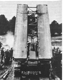
Die Nationale Volksarmee der DDR verfügt über moderne Brückenlegepanzer des Typs BLG-60, die – nach Ansichten von DDR-Millitärfachleuten – eine «Spitzenstellung» hinsichtlich ähnlicher Konstruktionen der NATO-Armee einnehmen. Die Scherenbrücke kann in kürzester Zeit abgelegt werden. Die Sturmbrücke ist variabel einszetbar und entspricht modernsten Ansprüchen.
