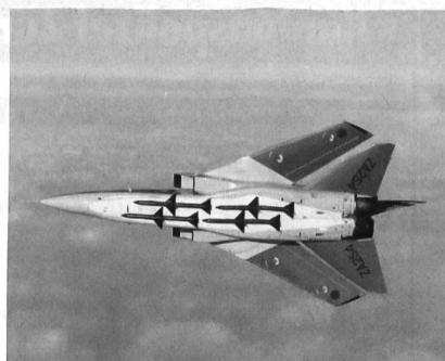
Zu Beginn des Jahres 1980 hatte der Prototyp des Langstrecken-Abfangjägers Tornado F.2 bereits mehr als 26 Flugstunden akkumuliert. Dabei erfolgte die Maschine eine Höchstgeschwindigkeit von Mach 1,8 und übernahm mehr
