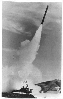
Die sowjetische SS-20-Rakete mit drei Nuklearsprengköpfen und einer Reichweite von 4500 km wird von einer mobilen Rampe abgefeuert. Mit den drei Sprengköpfen können drei verschiedene Ziele bekämpft werden. Dukas, Zürich
