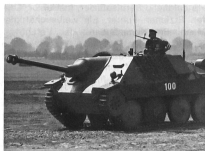
Modellfoto des Panzerkampfwagens 38 (t) «Hetzer». Bewaffnet mit der 7,5-cm-Pak 39/L48 und einem MG.
