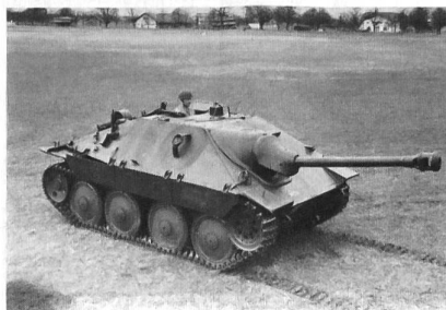
Panzerjäger G-13 der Schweizer Armee. Bewaffnet mit der 7,5-cm-Panzerabwehrkanone 1940 und 7,5-mm-MG 38.
