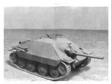
Modellfoto des Panzerkampfwagens 38 (t) «Hetzer». Bewaffnet mit der 7,5-cm-Pak 39/L48 und einem MG.
