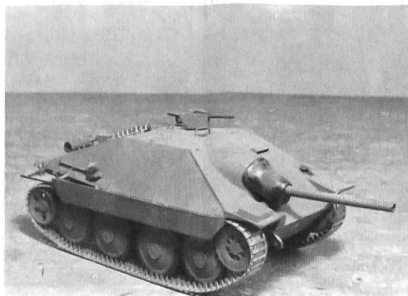
Modellfoto des Panzerkampfwagens 38 (t) «Hetzer». Bewaffnet mit der 7,5-cm-Pak 39/L48 und einem MG.
