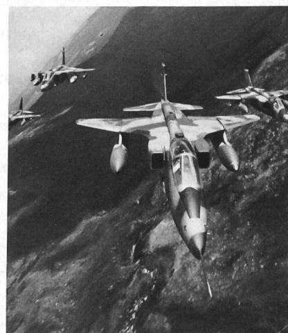
Luftwaffe bestimmten Jaguar-Apparaten handelt es sich um Maschinen der verbesserten Ausführung «International». Diese Version verfügt u. a. über zwei schubstärkere Adour-Turbinen des Musters RT-172-26 Adour Mk804 von je 2385 kp Standschub ohne und 3630 kp mit Nachbrenner. Weitere Ver-
