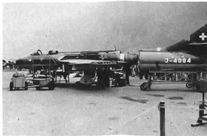
Revisionsarbeiten an einem Hunter. 10 Fachspezialistengruppen sind daran beteiligt. Der Arbeitsablauf ist im 24-Stunden-Betrieb gewährleistet.
